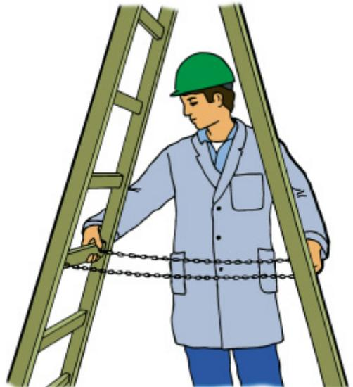
Die oberste Sprosse oder Stufe einer Stehleiter darf nur bestiegen werden, wenn sie dafür geeignet ist – z. B. bei einer Stehleiter mit Sicherheitsbrücke.
