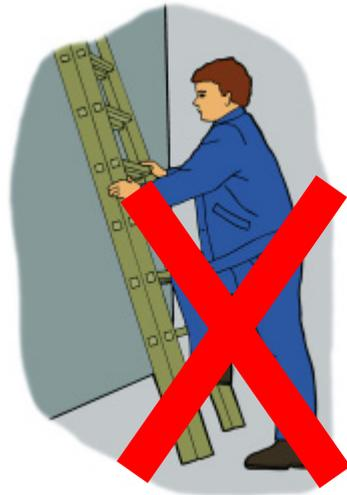
Durch eine solche Benutzung werden die Schanierbefestigungen überbeansprucht und die Leiter steht nicht sicher.
